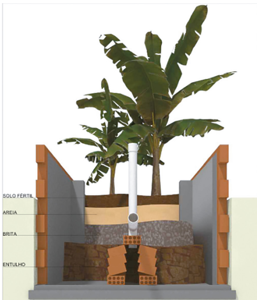
Figura 2 - Tanque de evapotranspiração (Tevap) (OTSS, 2015)
