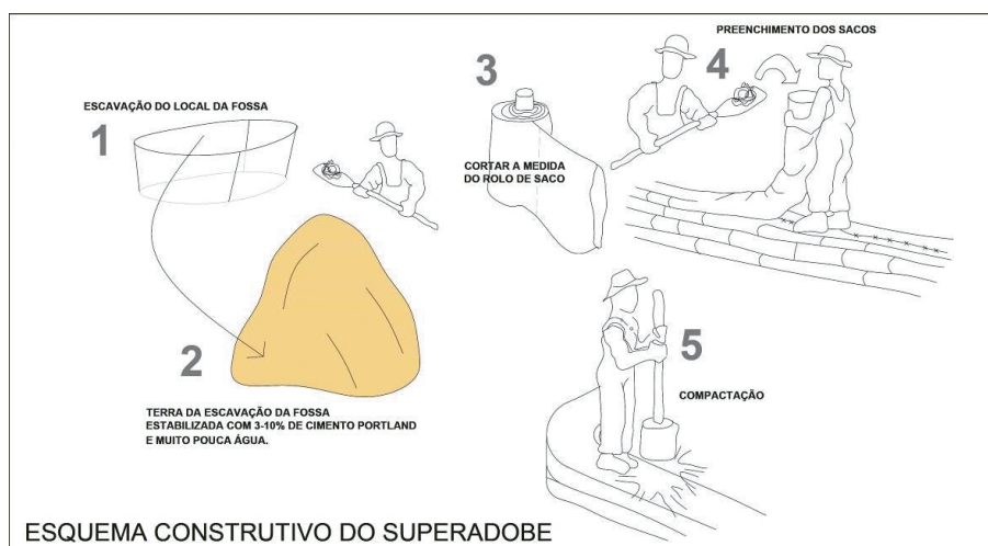
Figura 5 – Croquis do método construtivo do superadobe (OTSS, 2015)
